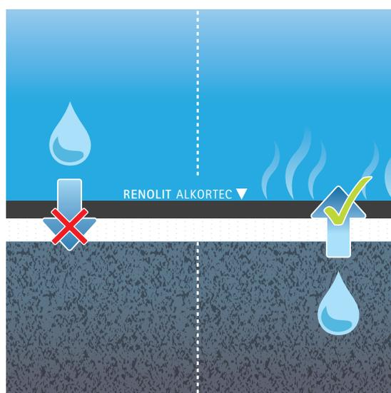
RENOLIT ALKORTEC tiene un valor  $\mu$  de 25.000 y puede considerarse abierta al vapor de agua.
