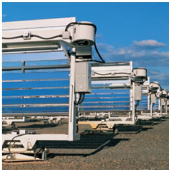
Se han realizado pruebas de envejecimiento de la membrana de estanqueidad RENOLIT ALKORTEC en Florida (clima tropical húmedo) y en Arizona (clima árido), en las condiciones más extremas posibles.
