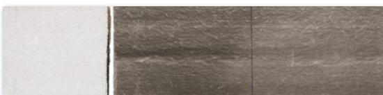
Кровельная мембрана на основе битума с гладким отражающим акриловым покрытием сверху
