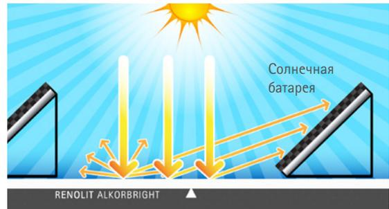
Повышение на 2°C вызывает снижение отдачи примерно на 1%. Отражающая белая кровельная мембрана, как, например, **RENOLIT ALKORBRIGHT**, создает более низкую температуру воздуха в зоне модулей фотогальванических элементов, а это, в свою очередь, повышает их эффективность.
