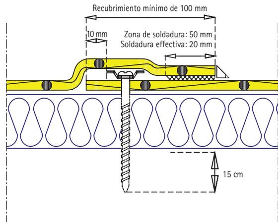
Fig. 1 Fijación mecánica y recubrimiento de los anchos
