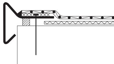
Fig. 5: Utilización de una junta de compresión **RENOLIT ALKORPLUS**<sub>81058</sub>
